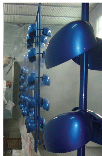
Instalación de transportador PFO 50+150/300 en la empresa Ficomirrors (Polonia)
